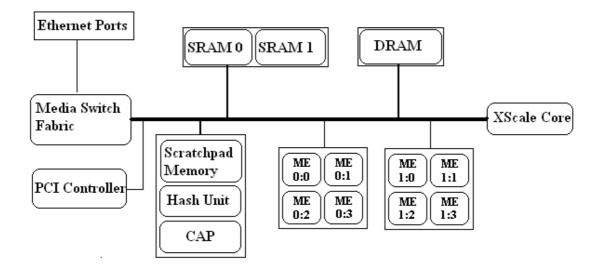
Figure 2.2: Intel IXP2400 Block Diagram
